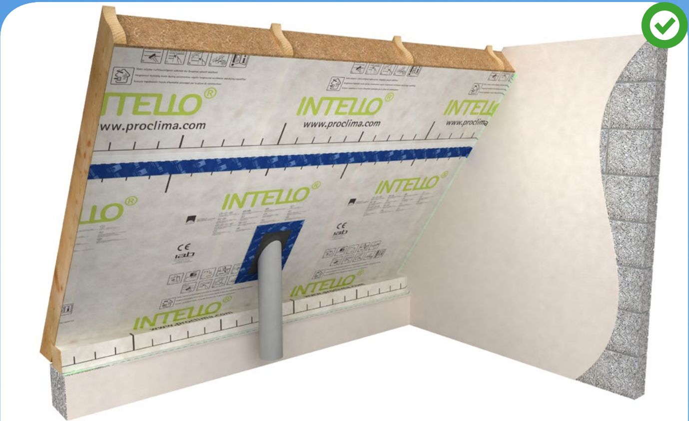
Vzduchotěsné napojení prostupu na parobrzdu systémem PRO CLIMA
